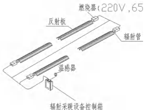
图 5 辐射采暖设备一区接线图
