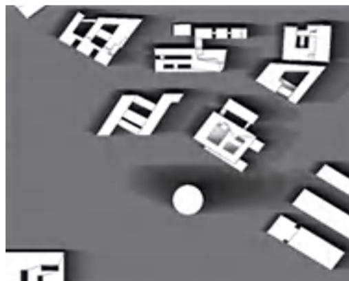
图 13 底部圆形建筑日影分布图
