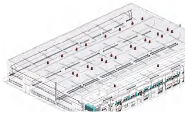
图 6 焊装车间暖通透视图
